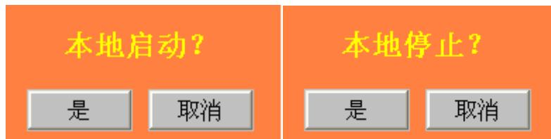
**本地停止：**点击 HMI 上停止按钮或按柜门上停止按钮停止。HMI 会有确认停止提示，如上图所示。
