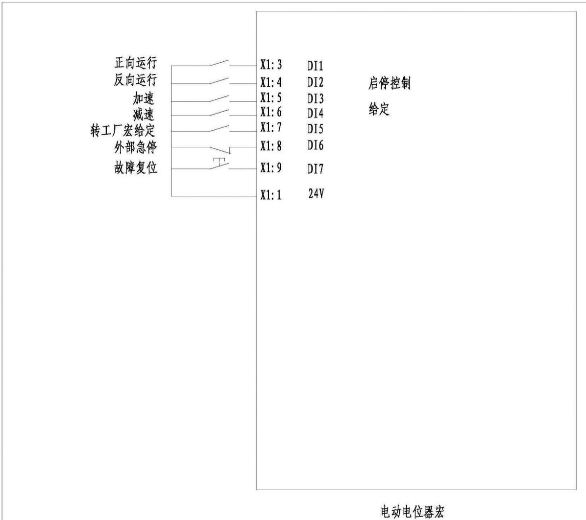
应用说明：“控制与给定”参数中“控制宏设置”参数项数值设定为8时，电动电位器宏有效。
