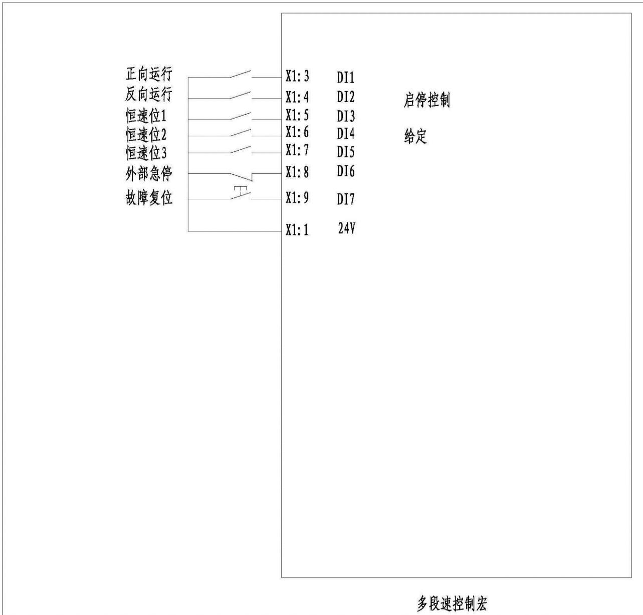
应用说明：“控制与给定”参数中“控制宏设置”参数项数值设定为16时，多段速宏有效。启动停止由DI1和DI2决定，同“工厂宏”。
